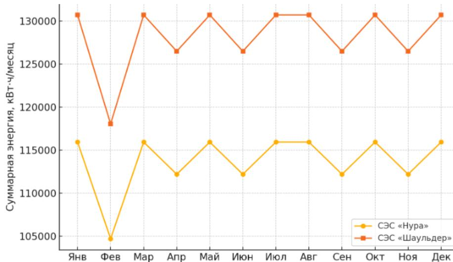
Рисунок 3.4 — Годовой профиль суммарной энергии для пилотного поля 1000 м<sup>2</sup> PV/T на СЭС «Нура» и «Шаульдер»
